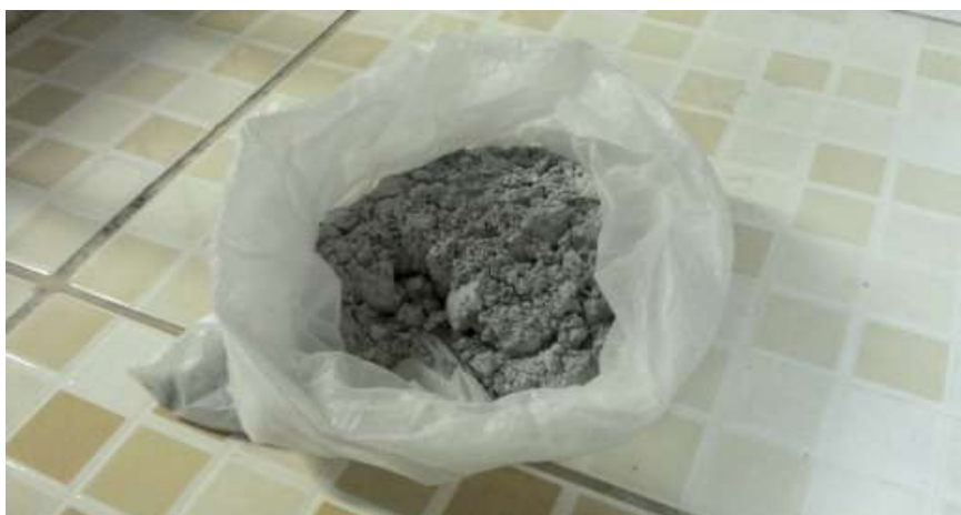
Figura 11 – Material abrasivo ( \text{Al}_2\text{O}_3 ) utilizado nas preparações das lamas abrasivas
