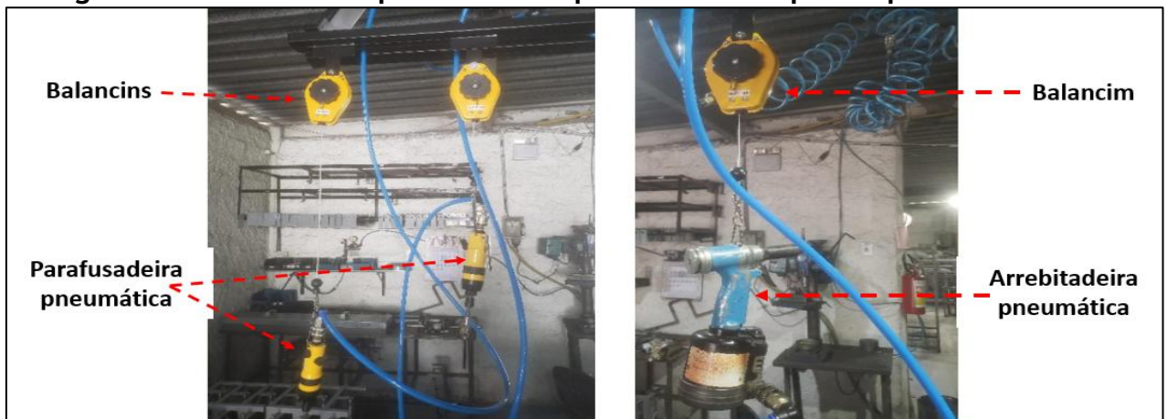
Figura 6 - Arrebiteadeira e parafusadeiras pneumáticas suspensas por balancins
