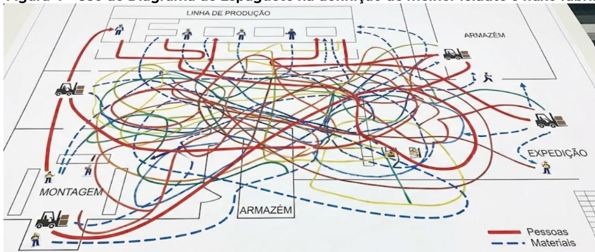
Figura 4 - Uso do Diagrama de Espaguete na definição de melhor leiaute e fluxo fabril
